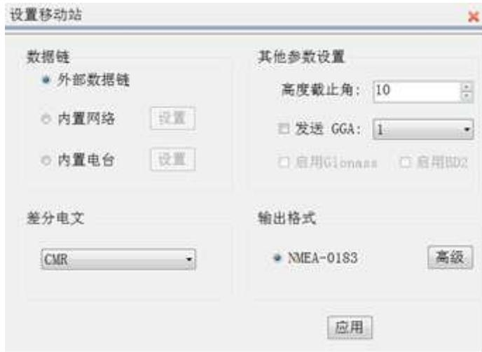
图 18-17 RTK 移动站设置
