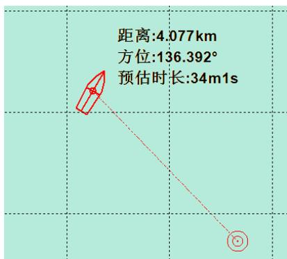
图 13-21 测量窗口显示的定点导航信息
