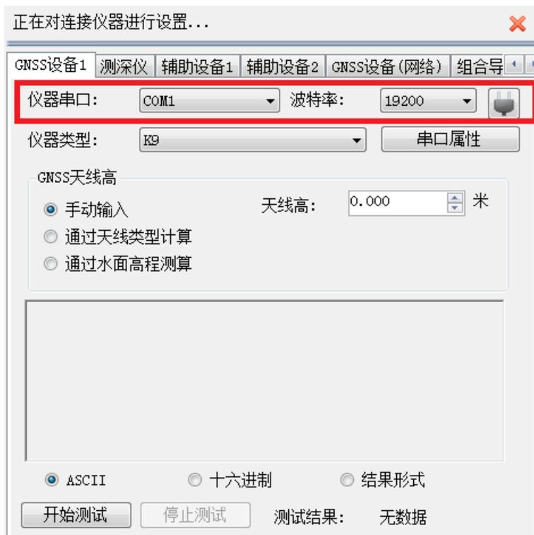
图 8- 1 GNSS 串口设置
