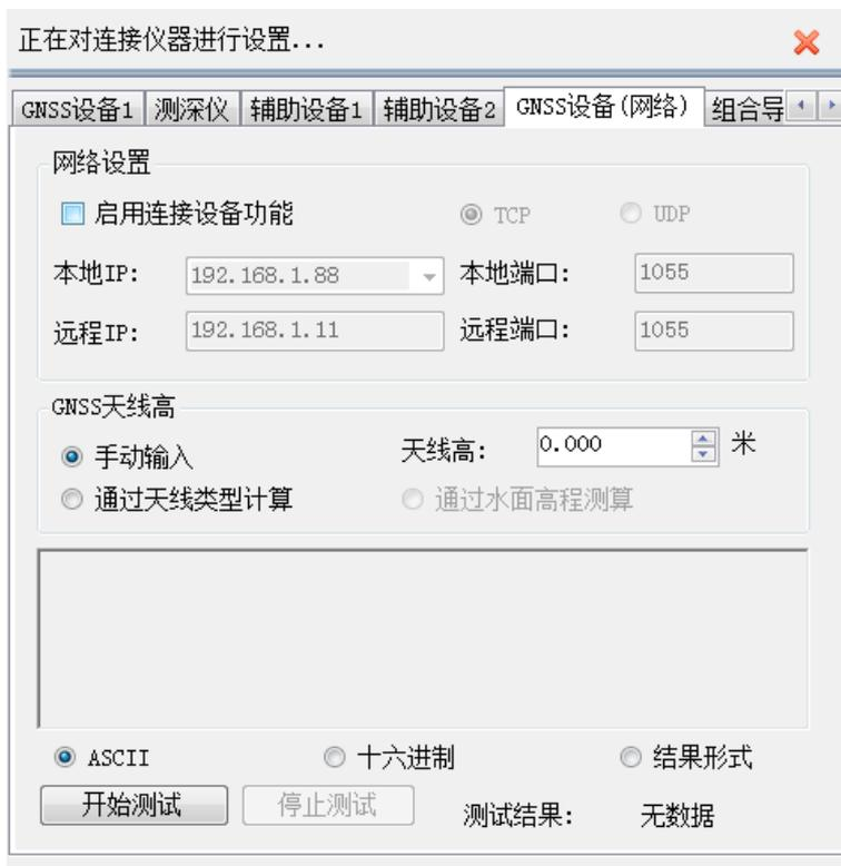
图 8- 13 GNSS 网络设备选项卡
